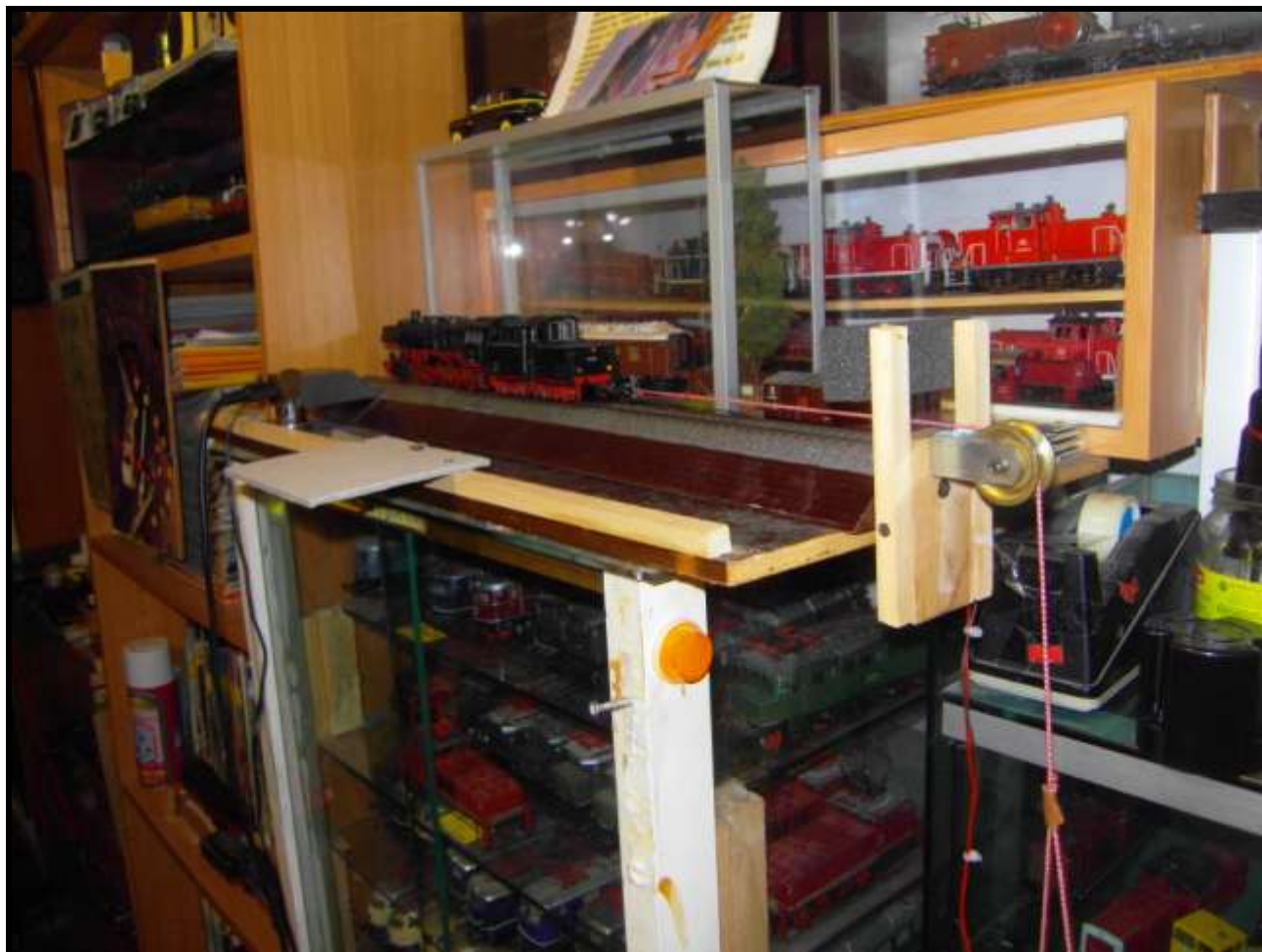
Foto n. 31: il banco dinamometrico è oggi gestito da una Mobile Station 1.
