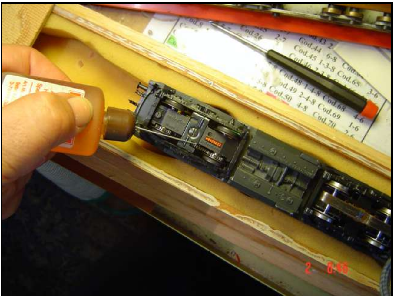
Foto n. 23: lubrificazione degli assi motori di un locomotore nella “culla”.
