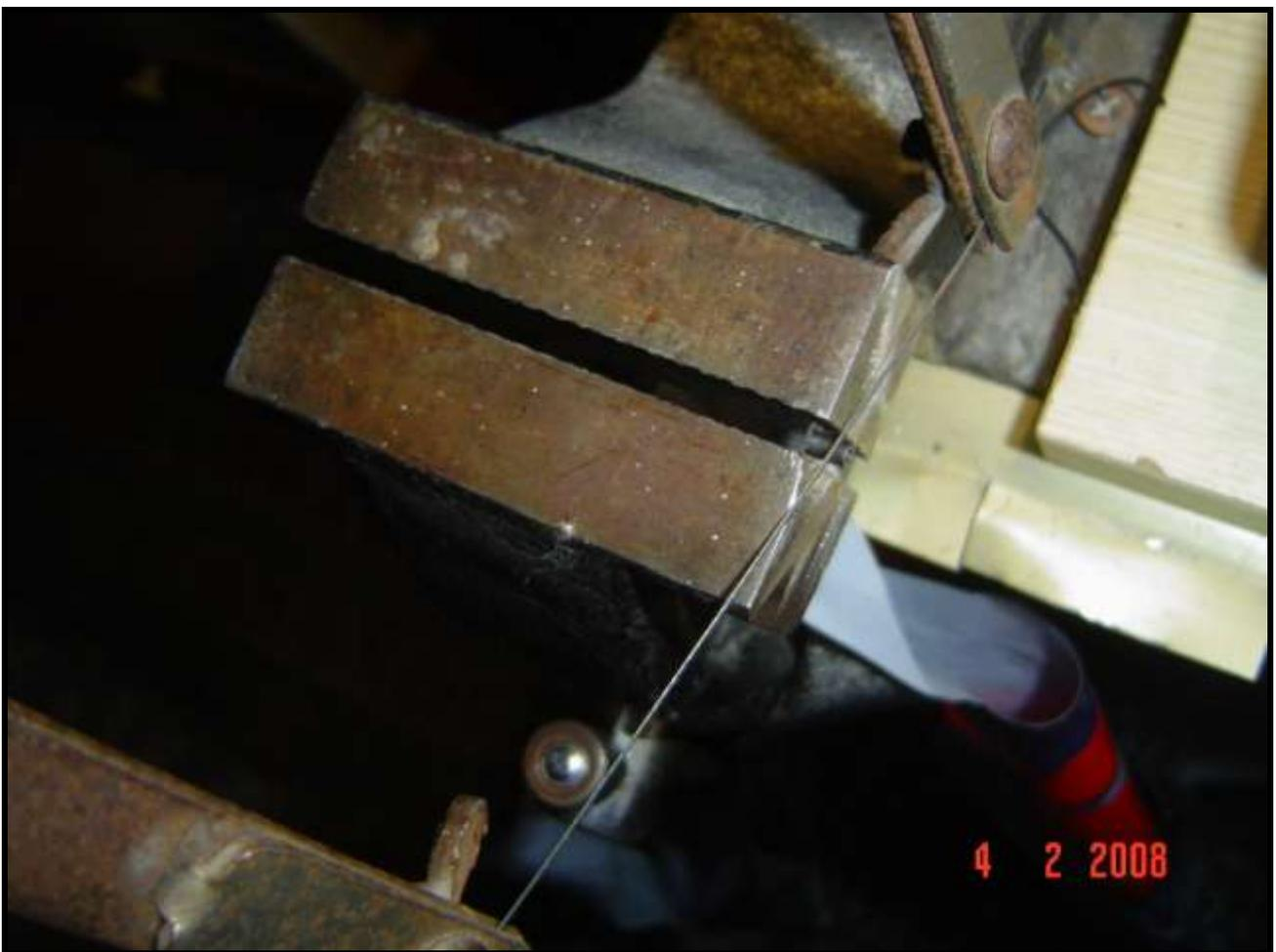
**Foto n. 13: il respingente serrato in una morsa viene accorciato con il traforo.**
