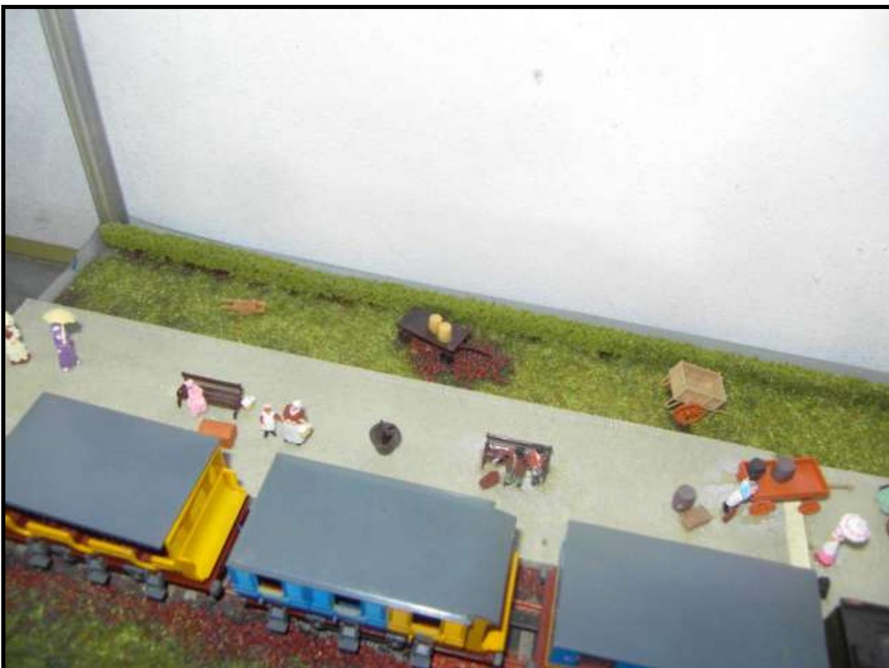
Foto n. 7: dall'alto si nota l'eccessiva larghezza delle carrozze Trix.
