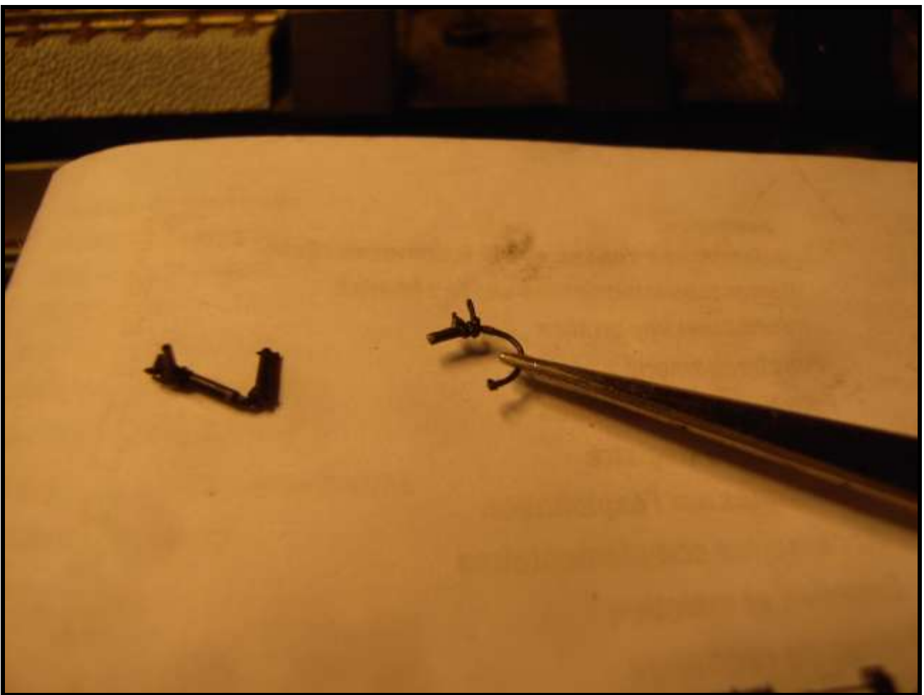
Foto n. 12: un tubo dei freni artigianale (il rec vapore a sinistra).
