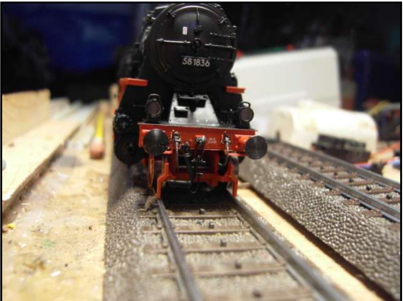
Foto n. 13: gancio, tubi dei freni e rec vapore montati.
