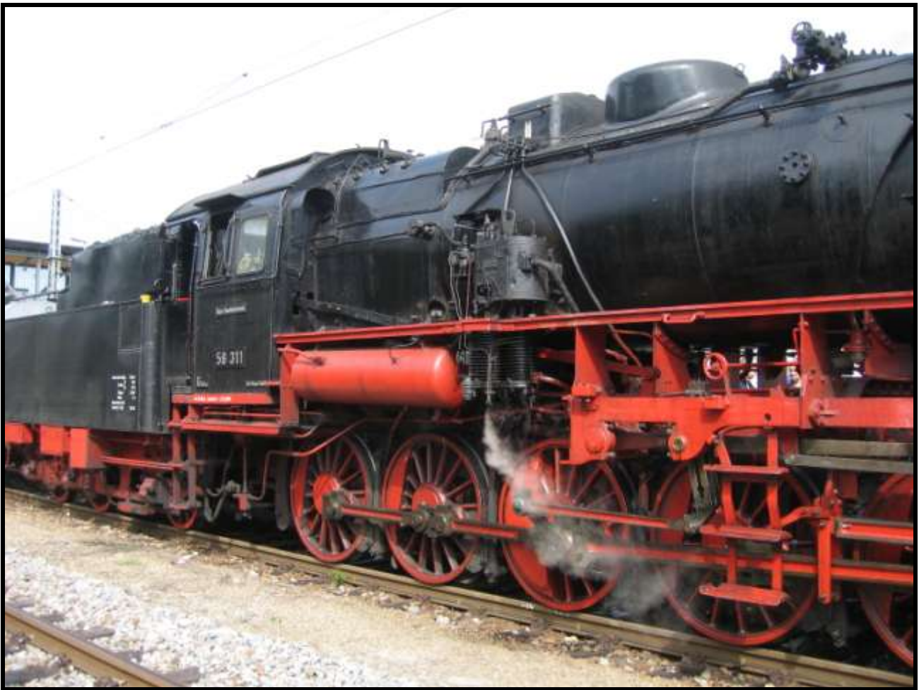
Foto n. 2: tender di tipo prussiano 3T 20 nella Br 58 311 a Göppingen.
