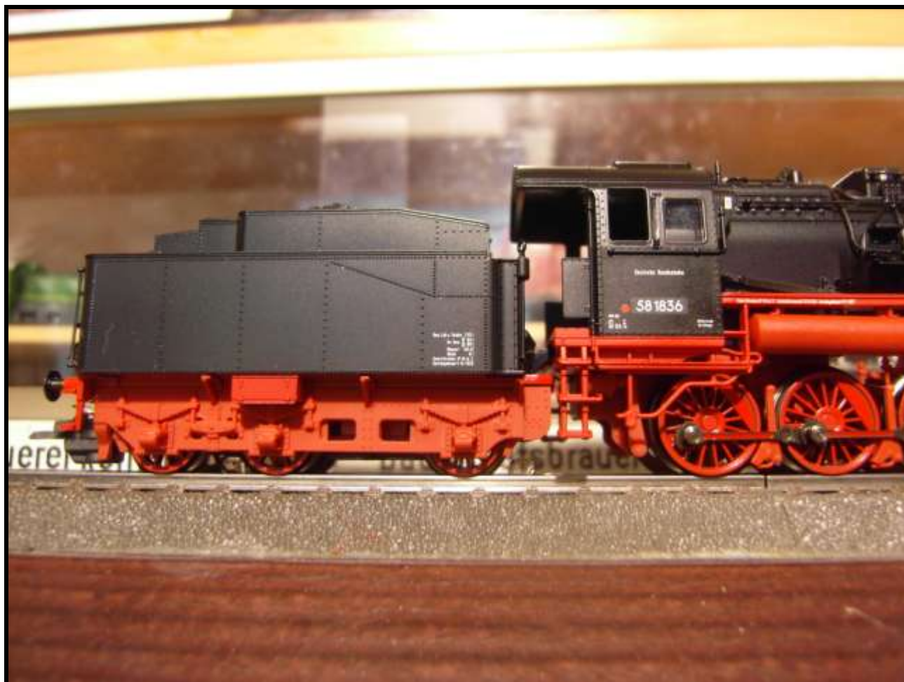
Foto n. 1: tender di tipo prussiano 3T 20 a tre assi.
