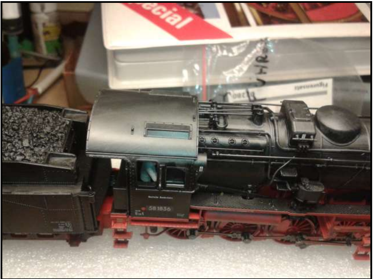
Foto n. 15: tetto della cabina e caldaia grafitati della Br 58 1836.
