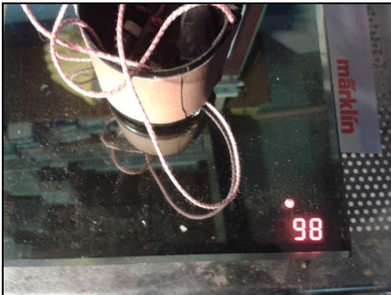
Foto n. 3: al risultato di 98 g, sul banco dinamometrico, vanno aggiunti 5 g per la resistenza del carro scudo.
