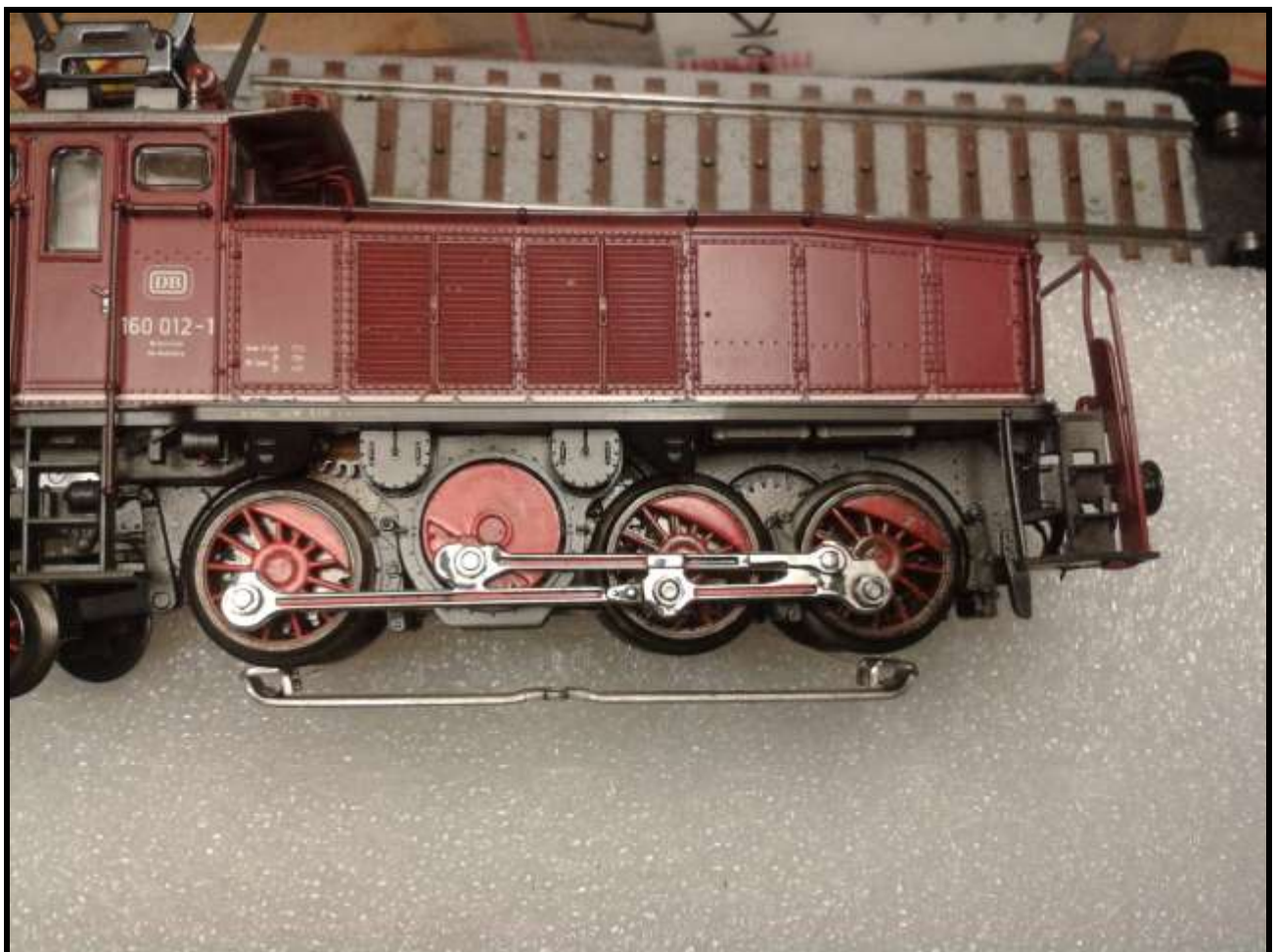
Foto n. 15: il carrello motore con bielle nella 160 da manovra.
