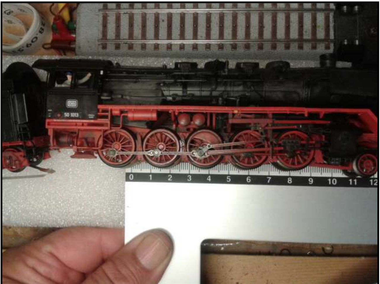
Foto n. 17: il passo della Br 50 1013 del 2012 è di ca 7,8 cm.
