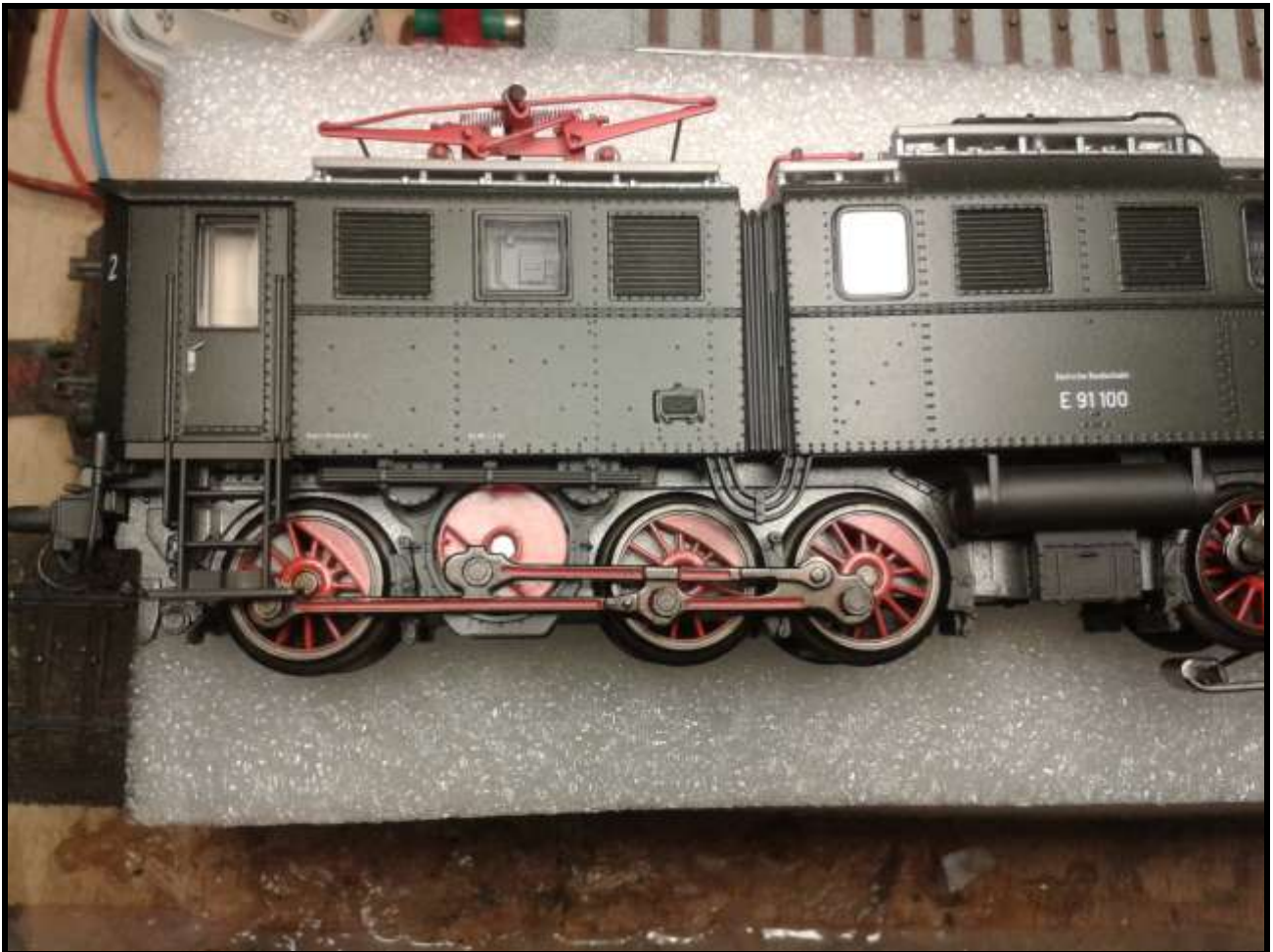
Foto n. 16: il carrello della 191 è in pratica quello della 160 da manovra, mentre nella vera il passo era molto più ampio.
