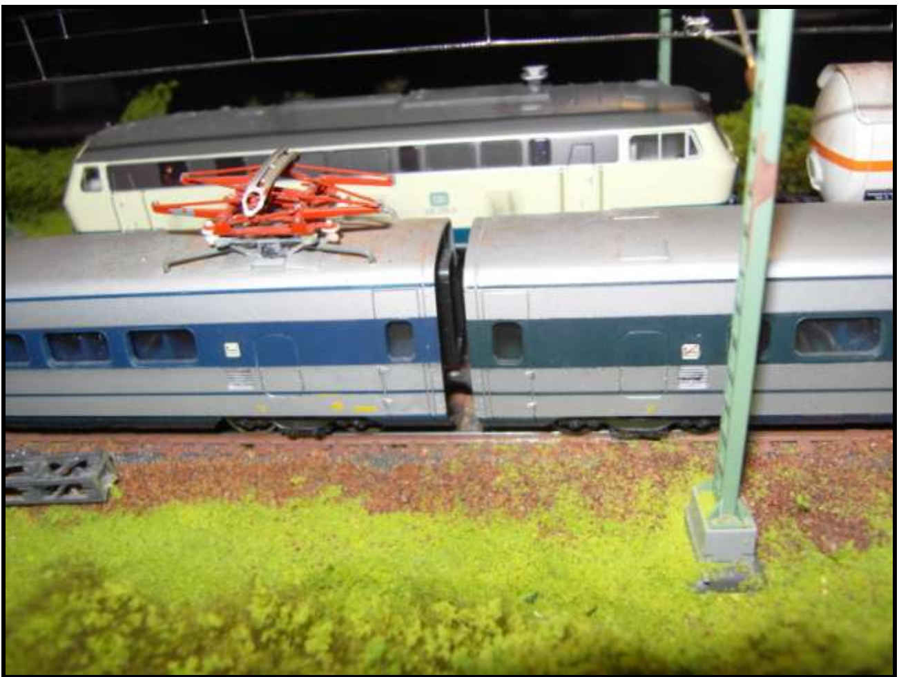
Foto n. 11: ETR 401 con nuovi pantografi GT e supporti sul tetto.
