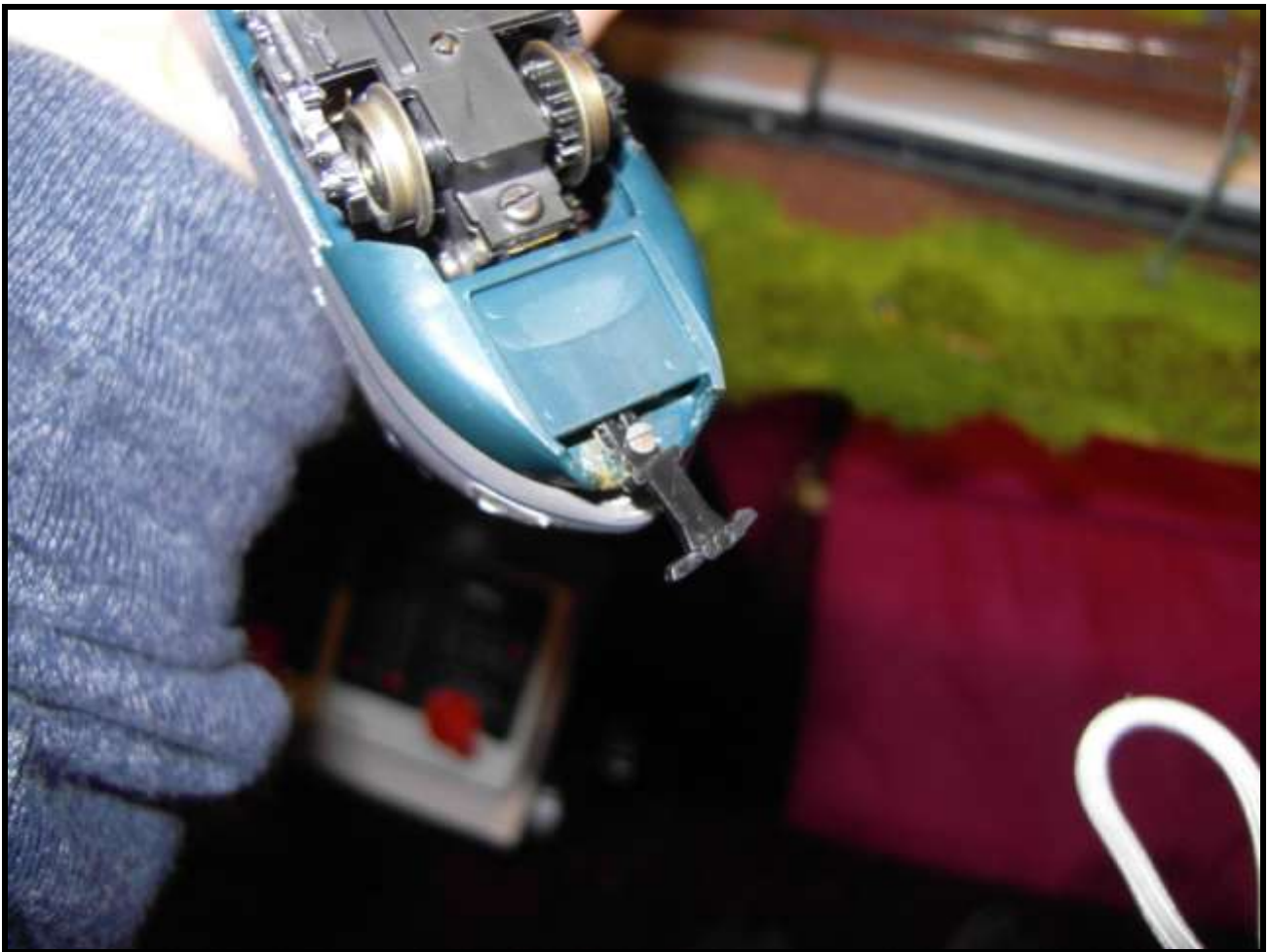
Foto n. 8: ETR 401 con il gancio a dentello avvitato e ingranaggi folli.
