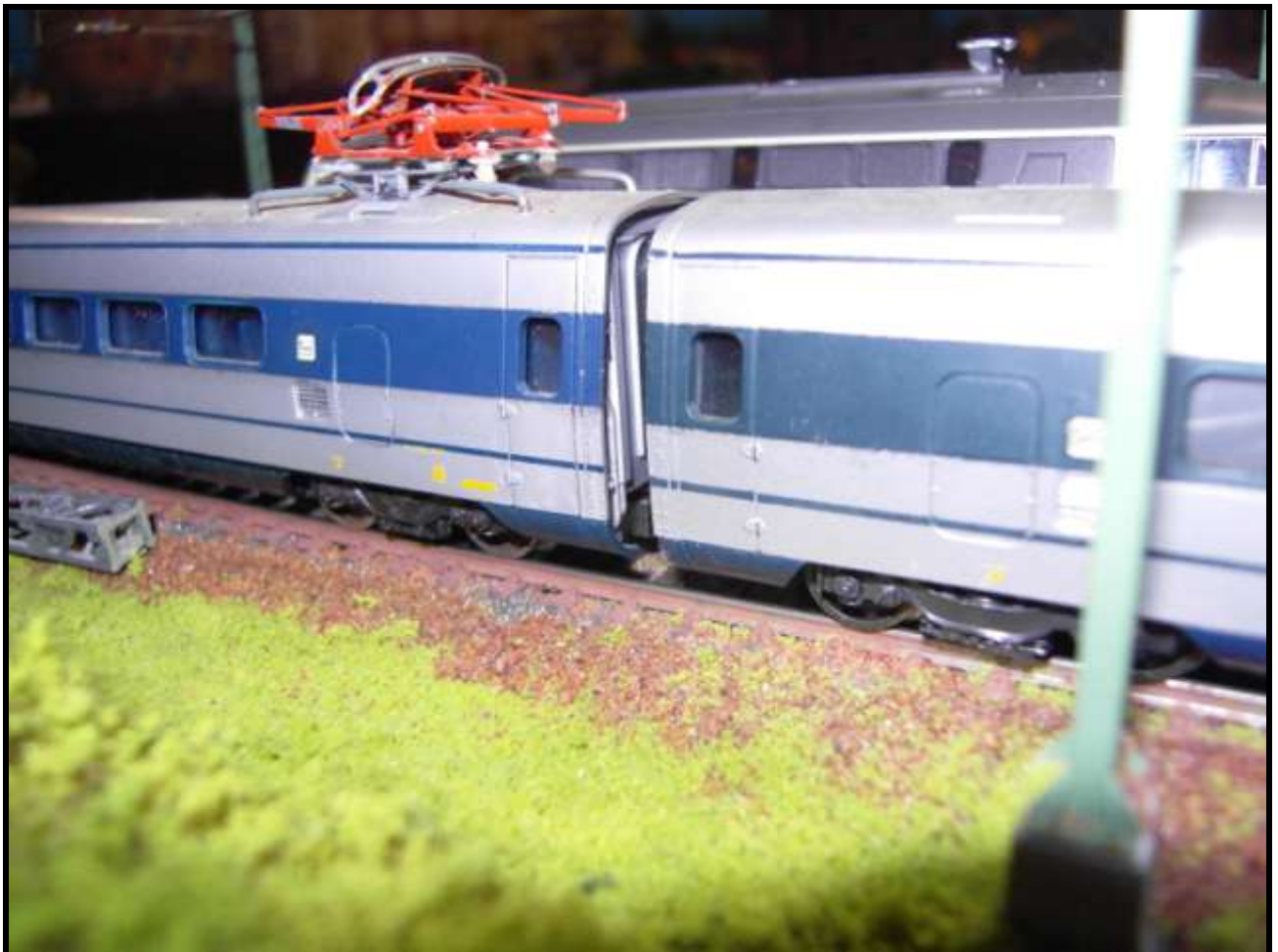
Foto n. 10: ETR 401 con nuovi pantografi GT e supporti sul tetto.
