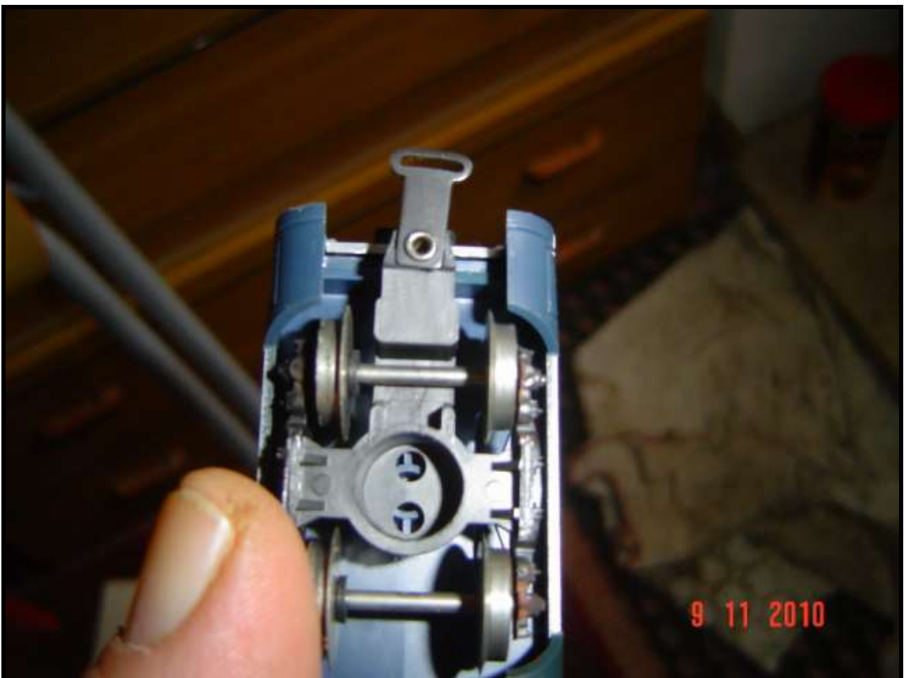
Foto n. 14: ETR 401 con ganci ad occhiello non modificati.
