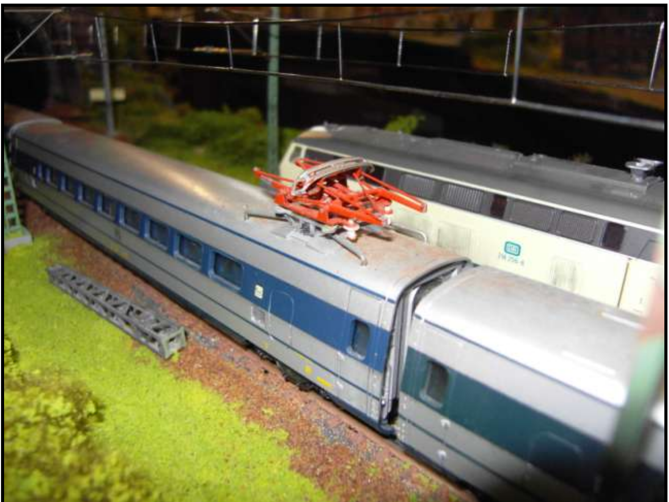
Foto n. 12: ETR 401 con nuovi pantografi GT e supporti sul tetto.
