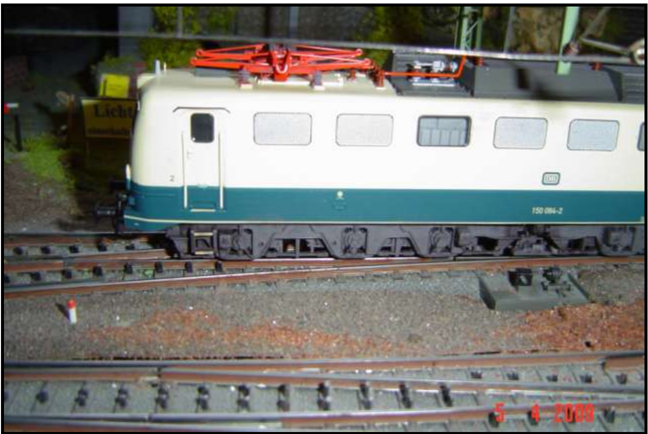
Foto n. 33: in questa 150 084-2 (art. 39501) gli isolatori e i carrelli sono stati verniciati ed invecchiati.
