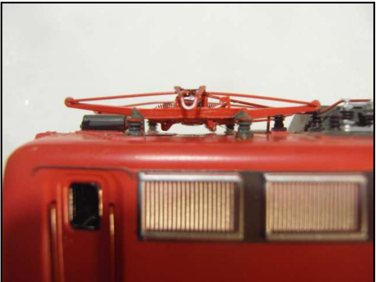
Foto n. 29: il pantografo in posizione chiusa.
