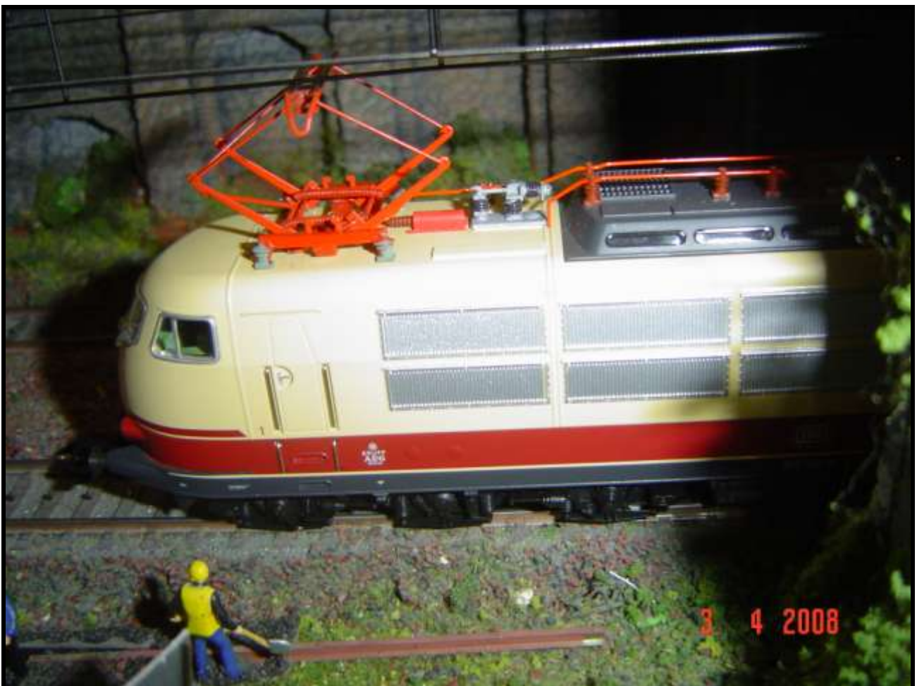
Foto n. 12: tutte le 103 sino al 2013 montano i pantografi art. 220433.
