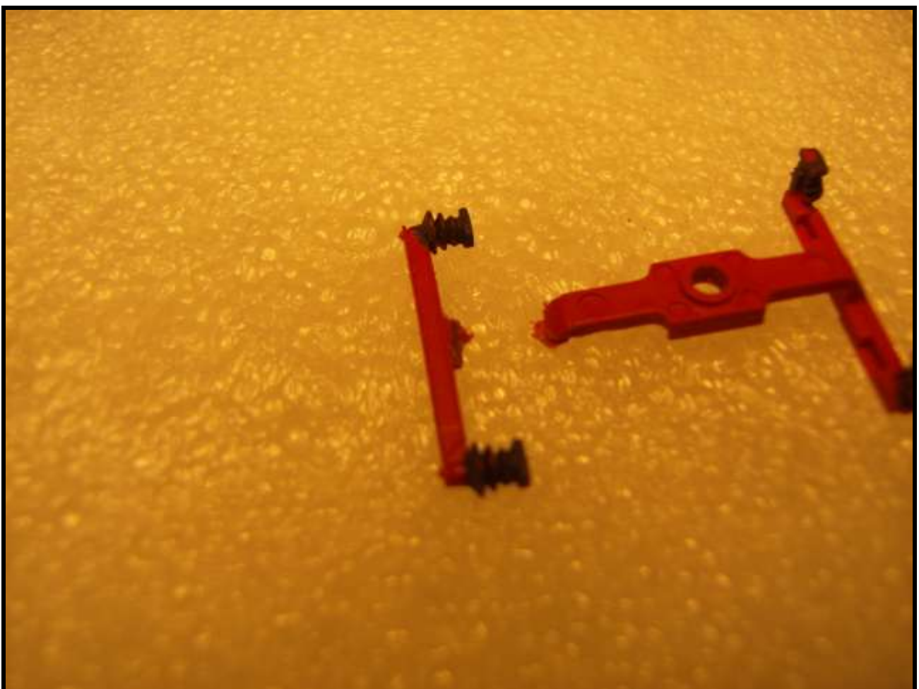
Foto n. 22: eventuali sbavature vanno eliminate.
