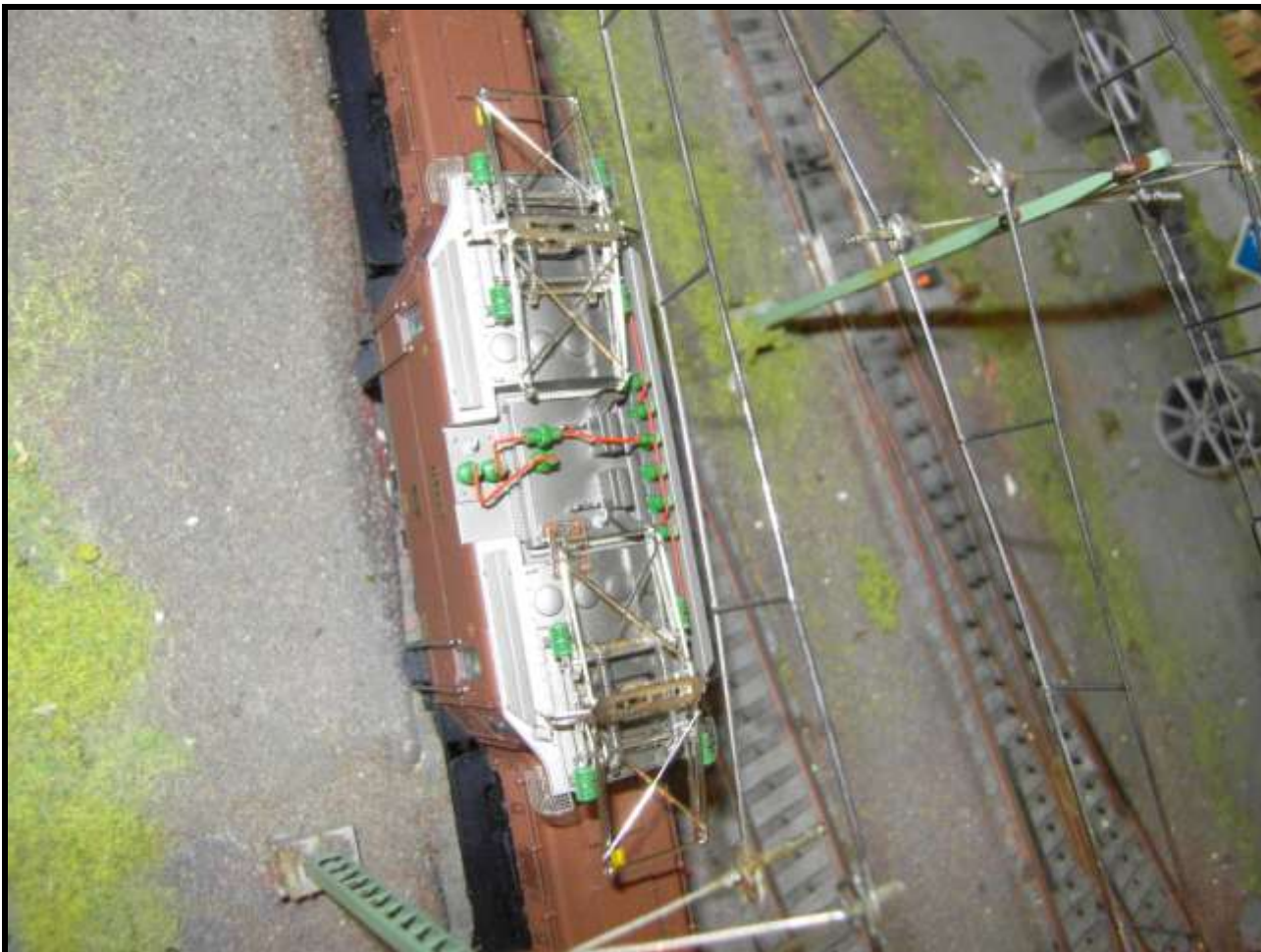
Foto n. 11: imperiale del Ce 6/8 II del 2013, i cavi sono in posizione diversa rispetto ai Ce 6/8 III, ma le molle sono sempre solo 2.
