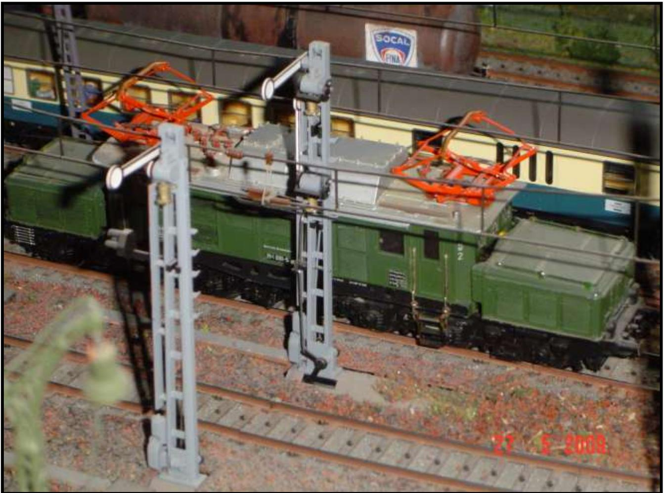
**Foto n. 2: una 194, del 1970, con corrimano riportati in filo d'acciaio da 0.6 mm  $\varnothing$ , con una complessa modifica.**
