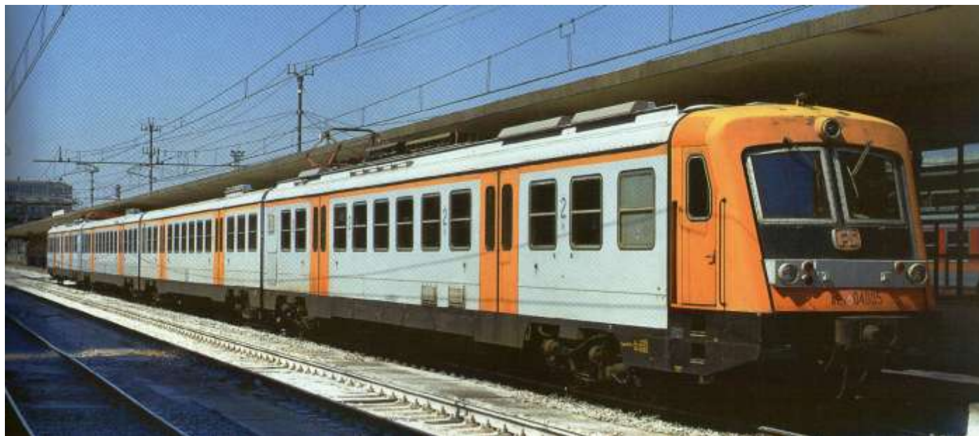
ALe 644 Treno GAI (Gruppo Aziende Italiane), capostipite di una nuova generazione di ETR ad azionamento elettronico (1997)
