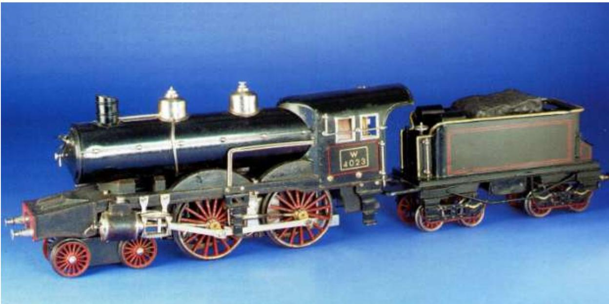
Il tender a quattro assi incorporava un capace serbatoio dell'acqua, necessario per la caldaia, ed inoltre aveva uno scompartimento per la batteria richiesta per l'illuminazione (il modello della foto è mancante dei fanali). Valvole di sicurezza, fischi, e vetri ai finestrini della cabina completavano la dotazione.
